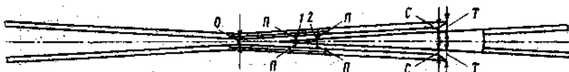
Рисунок 4.34. Места контрольных измерений ширины желобов в острой крестовине:
