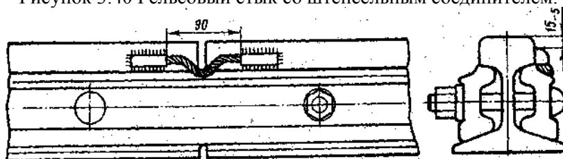
Рисунок 3.41 Соединитель, приваренный к головке рельсов.
