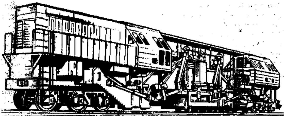
Рисунок 11.27 Выправочно-подбивочно-рихтовочная машина ВПО-3000.
