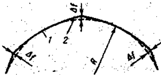
Рисунок 9.3 Очертание рабочей грани наружного рельса в кривой на звеньевом пути:
